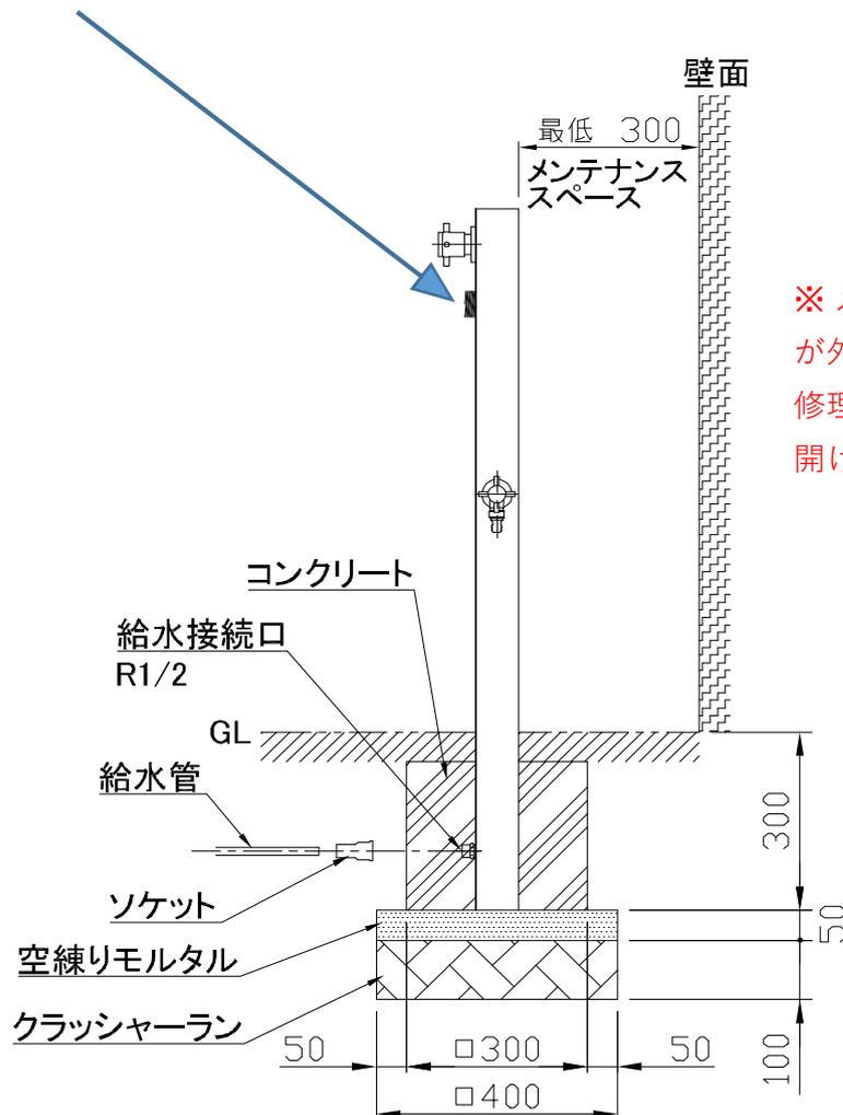
※ メンテナンス用に背面の板が外せるようになっています。修理等のために作業用の空間を開けてください。
