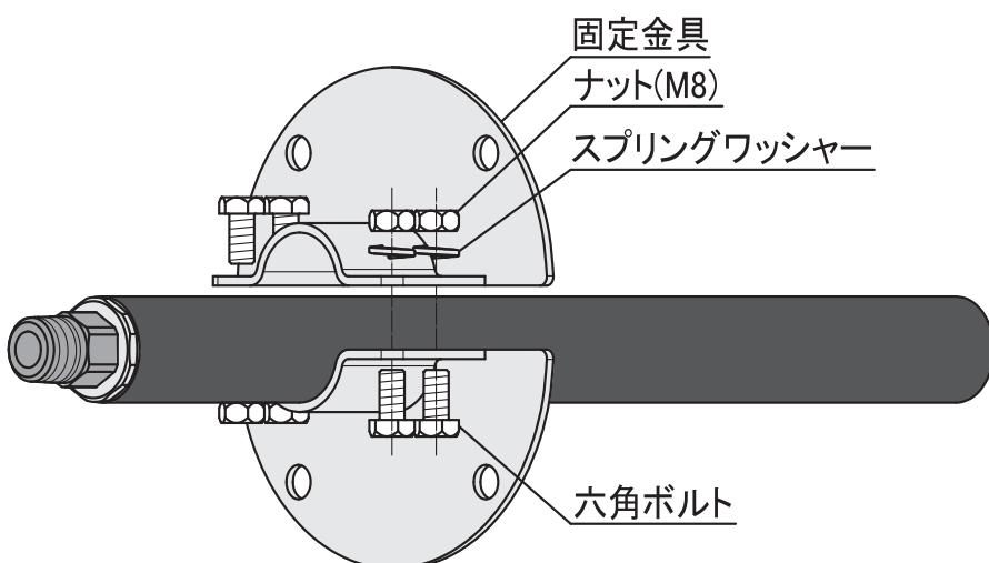
④水栓柱をウッドデッキにあけた穴に通して、配管に接続します。
